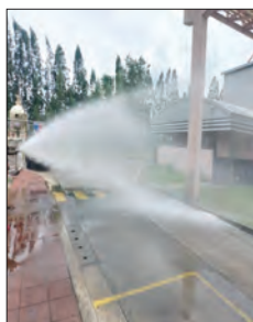
Photo 2.12 ทดสอบฉีดน้ำปลายสายที่จุดไกลสุด
