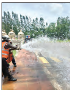
Photo 2.12 ทดสอบฉีดน้ำปลายสายที่จุดไกลสุด
